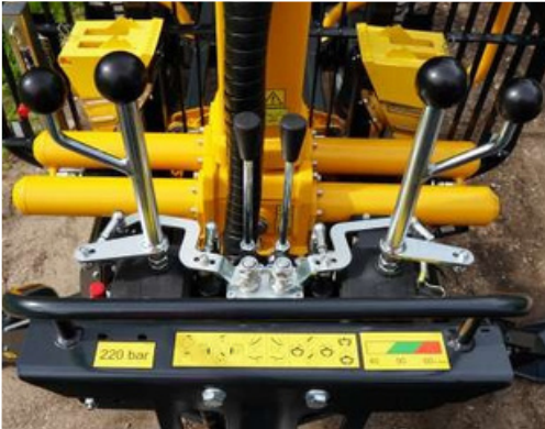
Vezértömb 4/8 XYZ vezérléssel
