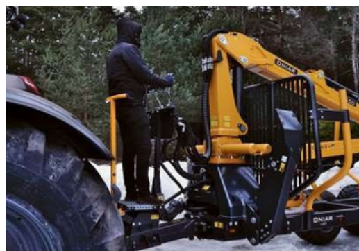
Kezelőállvány a vonórúdon, alatta hidraulika szivattúval
