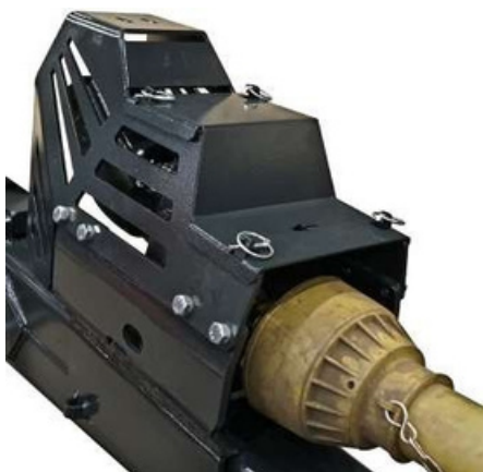
Védett dugattyús szivattyú és gyorsító áttétel a vonórúdon
