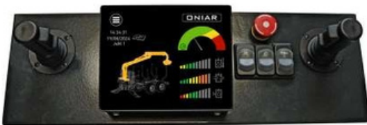
Mini joystickek kijelzővel Lehetővé teszi a kezelő számára az egyed darufunkciók beállításainak módosítását és mentését. A kijelző mutatja a daru terhelését, ami a traktor üzemanyag-fogyasztásának csökkentésére is használható.
