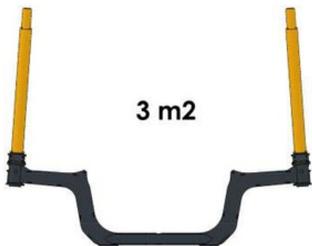
GROUP 3 RAKONCÁK RAKFELÜLET NÖVELÉSSEL NYITOTT ÁLLÁSBAN
